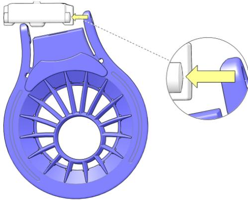
5. Per l'installazione, posizionare un'aletta del supporto bicchiere sul perno della cerniera nella porta.
