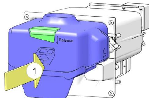
7. Inserire il gruppo caffè nel telaio di montaggio e spingere finché non si blocca. Accertarsi che il dispositivo di bloccaggio (in verde nell'immagine) sia completamente rilasciato.
