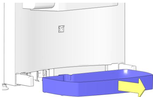
2. Tirare il vassoio antigoccia in direzione della freccia e rimuoverlo dalla macchina.
