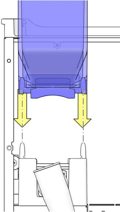
11. Spingere nuovamente la chiusura scorrevole del contenitore in direzione della freccia per aprire il contenitore dei grani e fissarlo alla base del macinacaffè.
