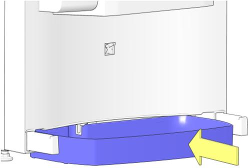
6. Posizionare il supporto caraffa sulle guide (2) e inserirlo in direzione della freccia.
