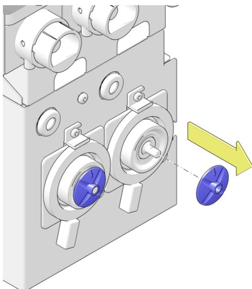
6. Ruotare nuovamente gli attacchi a baionetta in senso antiorario (ca. 10°) per sganciarli e rimuoverli dalla macchina in direzione della freccia.
