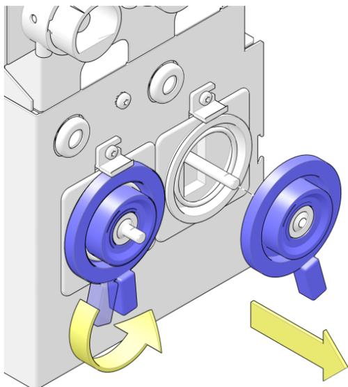
7. Tirare il cassetto filtro di scarico in direzione della freccia e rimuoverlo dalla macchina.
