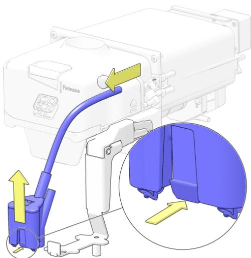
2. Rimuovere il gruppo caffè dalla macchina per caffè: posizionare quattro dita nell'impugnatura inferiore (1). Usando il pollice, premere e tenere premuto il dispositivo di bloccaggio (2) ed estrarre il gruppo caffè dal telaio di montaggio in direzione della freccia (3).
