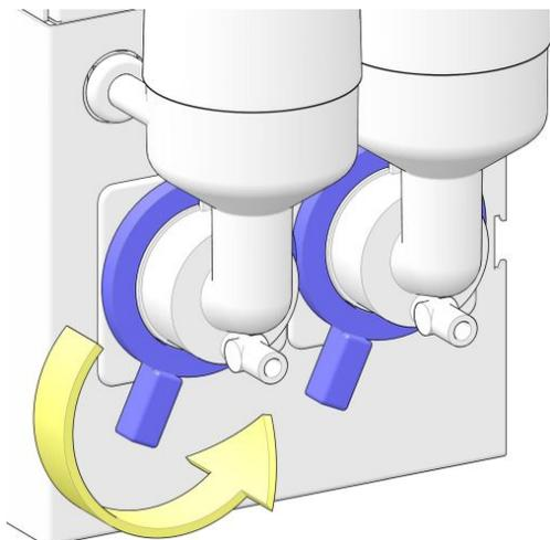
4. Tirare le camere di miscelazione in direzione della freccia e rimuoverle dalla macchina.
