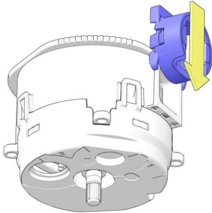
10. Inserire la bocchetta sulla camera di macinatura in direzione della freccia.
